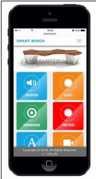
I dati rilevati dai sensori sono immagazzinati sul Web server interno e sono visualizzabili direttamente sull'interfaccia utente oppure possono essere inviati a un sito web esterno o essere scaricati per effettuare delle statistiche e report.
